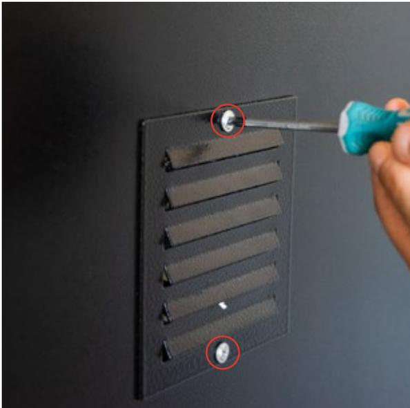
**1.** Smontare il carter verniciato laterale destro svitando le viti di fissaggio (utilizzare un giravite a stella)
