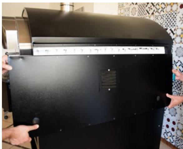
2. Una volta svitate tutte le viti, potete procedere a rimuovere il pannello laterale. È consigliabile eseguire l'operazione in due così da evitare di causare danni al forno o al circuito elettrico interno.
