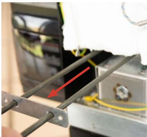
5. Estrarre e sostituire la resistenza.
