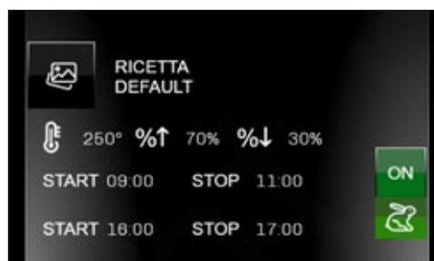
Lo stato di ON attiverà il preriscaldamento della ricetta impostata regolando in base alla configurazione della macchina. La LEPRE, attiverà il preriscaldamento in modalità riscaldamento rapido.
