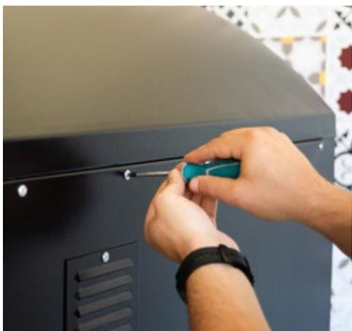
1. Smontare il carter verniciato laterale destro svitando le viti di fissaggio (utilizzare un giravite a stella).
